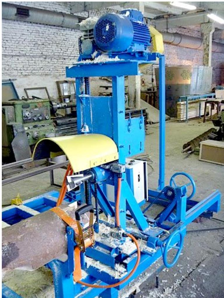
Станок фрезерный УСБ-1 предназначен для выборки пазов различной формы в торцах оцилиндрованного бревна и бруса при изготовлении срубов в деревянном домостроении.
