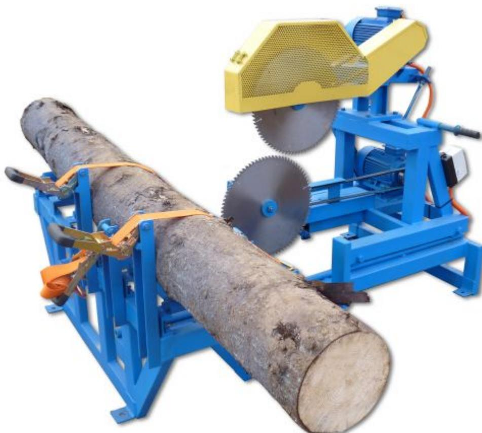
Станок торцовочный двухдисковый ТДБ-2 предназначен для торцовки бревен и бруса больших сечений. Используется как компонент линий по производству оцилиндрованного бревна и профилированного бруса.
