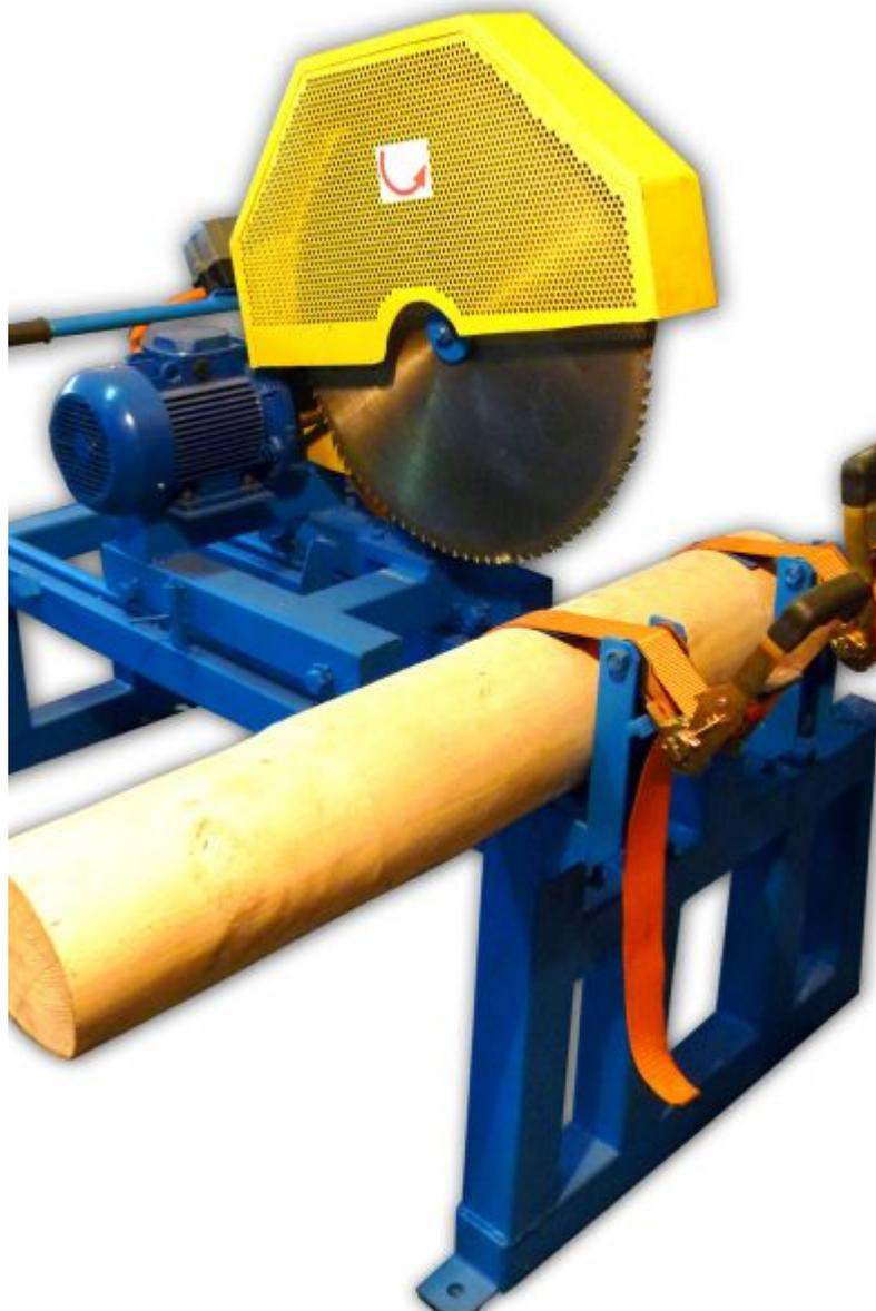
Станок дисковый для торцовки бревен ТДБ-1 предназначен для торцовки бревен и бруса. Используется как компонент линий по производству оцилиндрованного бревна и профилированного бруса.
